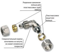
Латунные обжимные фитинги HENCO имеют корпус из высококачественной коррозионностойкой латуни CW617N/CW614N, имеют уплотнительные кольца из EPDM каучука, разрезное металлическое зажимное кольцо и латунные гайки. На штуцерах фитинга есть пластиковое диэлектрическое кольцо, которое исключает прямой гальванический контакт между металлом трубы и корпусом фитинга. Корпус фитинга покрывается оловом только снаружи не затрагивая резьбу с середины 2015 года. До этого применялось полное лужение фитинга.
